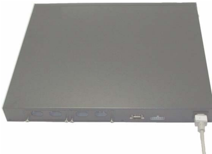
図 1-2 電源ケーブルの接続
