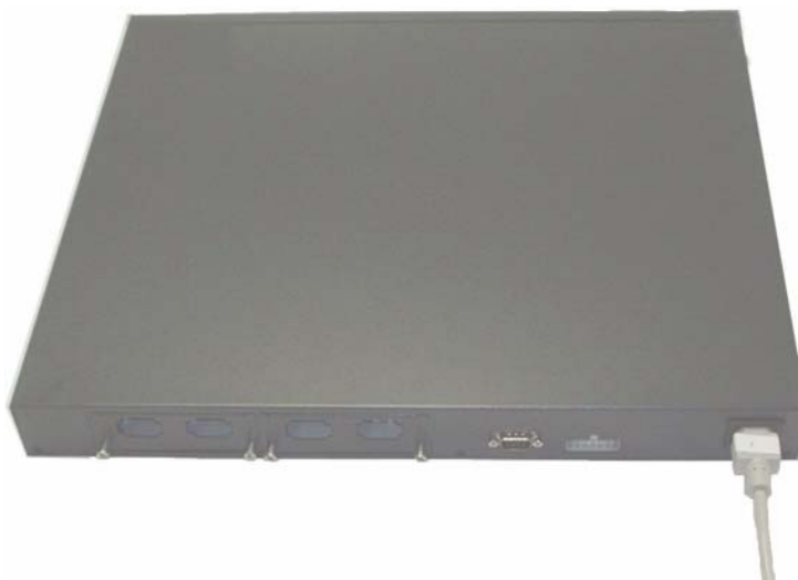
Figure 1-2. Branchement du câble d'alimentation
